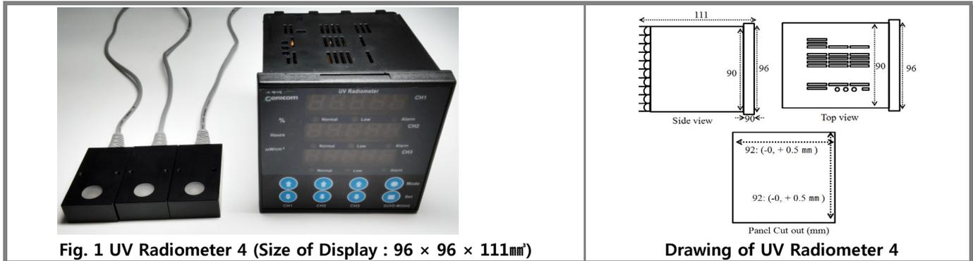
Fig. 1 UV Radiometer 4 (Size of Display : 96 × 96 × 111mm<sup>3</sup>)
